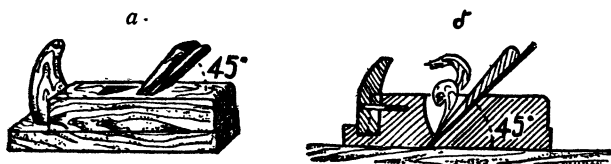
Рис. 23. Рубанок: а — внешний вид, б — разрез.
