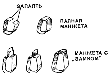
Рис. 212. Изготовление манжет.
